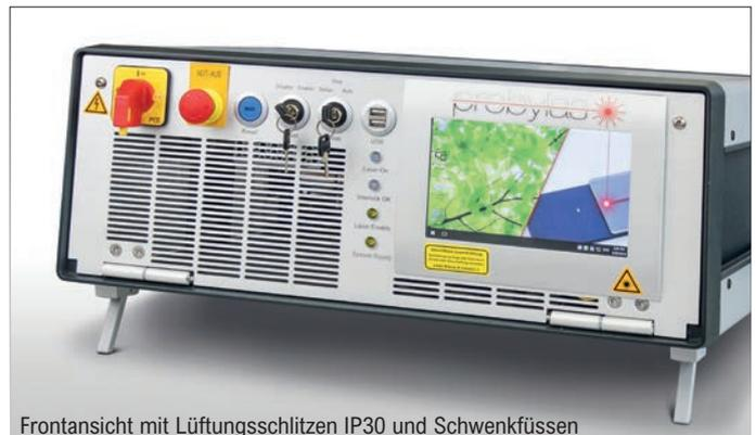
Frontansicht mit Lüftungsschlitzen IP30 und Schwenkfüssen
