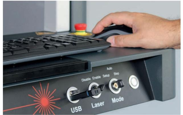
USB-Anschluss für Speichermedium oder zusätzliche Bedienelemente wie Maus und Tastatur.
