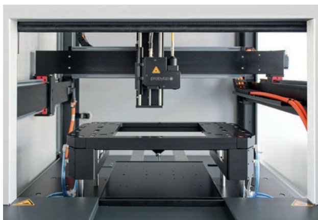
Grande plage de soudage allant jusqu'à 470 x 470 mm avec système d'axes comprenant axe Z vertical et grande unité de serrage.
