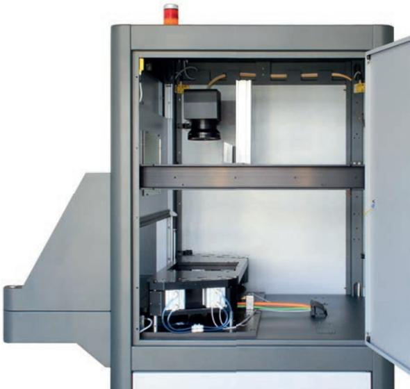
Buen acceso al área de soldado con unidad de sujeción, componentes ópticos, y sistema de moción a través de las puertas laterales.
